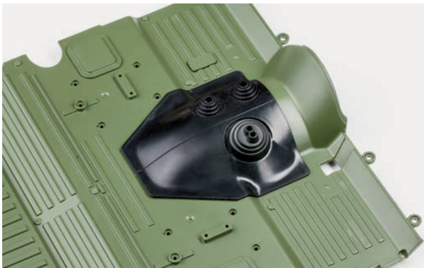
Шаг 7. Поместите собранную крышку поверх люка коробки передач в полу салона. Совместите семь крепежных штырей крышки с ответными отверстиями и плотно прижмите деталь к полу салона.
