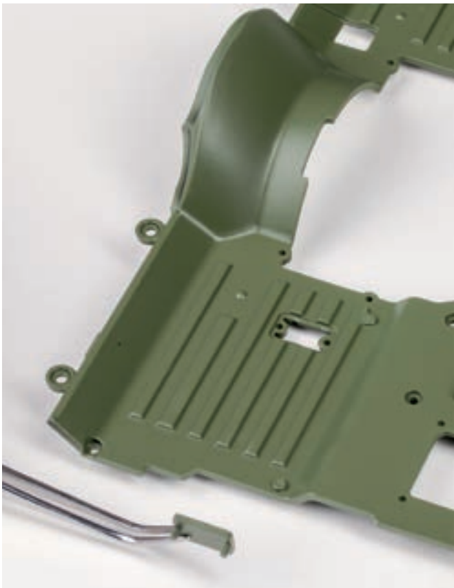
Шаг 1. Установите крышку люка главного тормозного цилиндра в левой передней части пола салона. Совместите крепежные штыри крышки с ответными отверстиями пола и плотно прижмите детали друг к другу.
