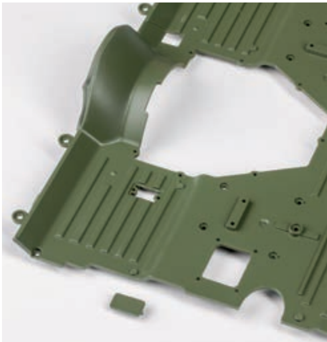
Шаг 1. Установите крышку люка главного тормозного цилиндра в левой передней части пола салона. Совместите крепежные штыри крышки с ответными отверстиями пола и плотно прижмите детали друг к другу.
