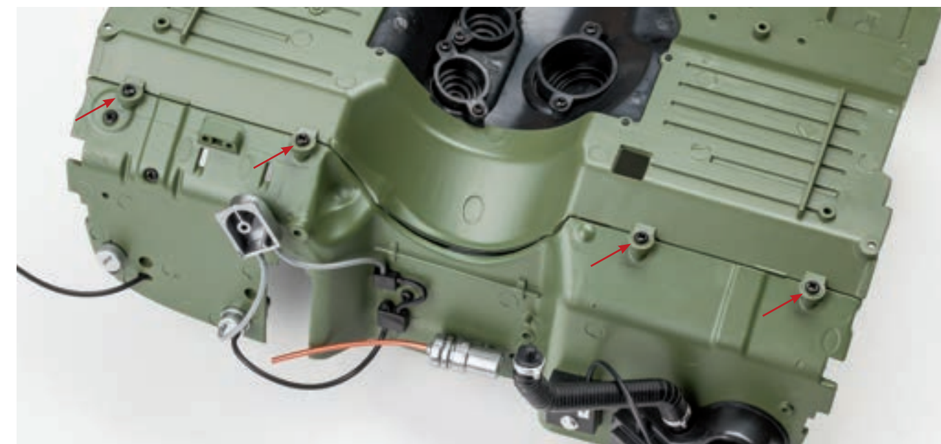
Шаг 8. В передней части пола салона установите собранную ранее перегородку моторного отсека. Совместите крепежные отверстия в нижней части перегородки с ответными кронштейнами, расположенными в передней части пола салона, и закрепите детали при помощи четырех винтов 2,3×4 (PM). По окончании монтажа возможно неплотное прилегание перегородки к элементам центрального тоннеля в передней части пола салона. В таком случае необходимо немного ослабить фиксирующие винты (не более чем на четверть оборота) — в результате появится зазор в узлах крепления деталей и возможность плотного прижима перегородки и центрального тоннеля. В дальнейшем (сборка в выпуске 54) соединение двух элементов усилится боковыми панелями, расположенными в ногах водителя и переднего пассажира. Таким образом удастся зафиксировать перегородку с минимальным зазором по линии прилегания центрального тоннеля пола.
