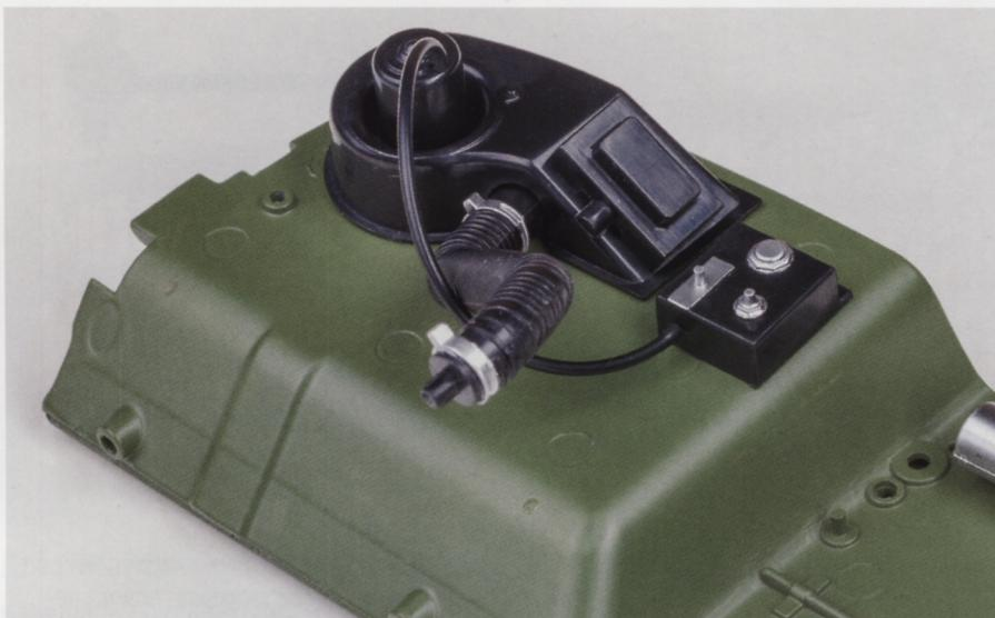
**Шаг 8.** Закрепите свободный конец провода мотора вентилятора на нижнем крепежном штыре корпуса щитка управления предпускового подогревателя.
