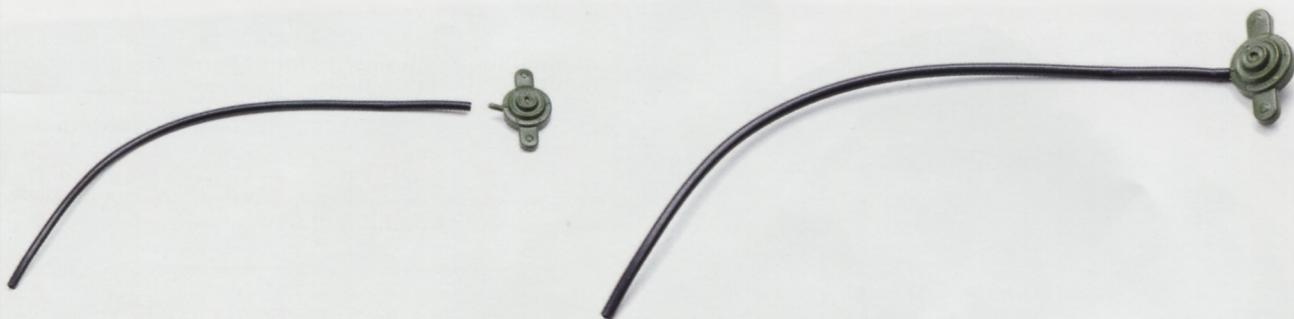
**Шаг 11.** На корпусе ножного насоса стеклоомывателя закрепите трубку бачка стеклоомывателя длиной 90 мм.
