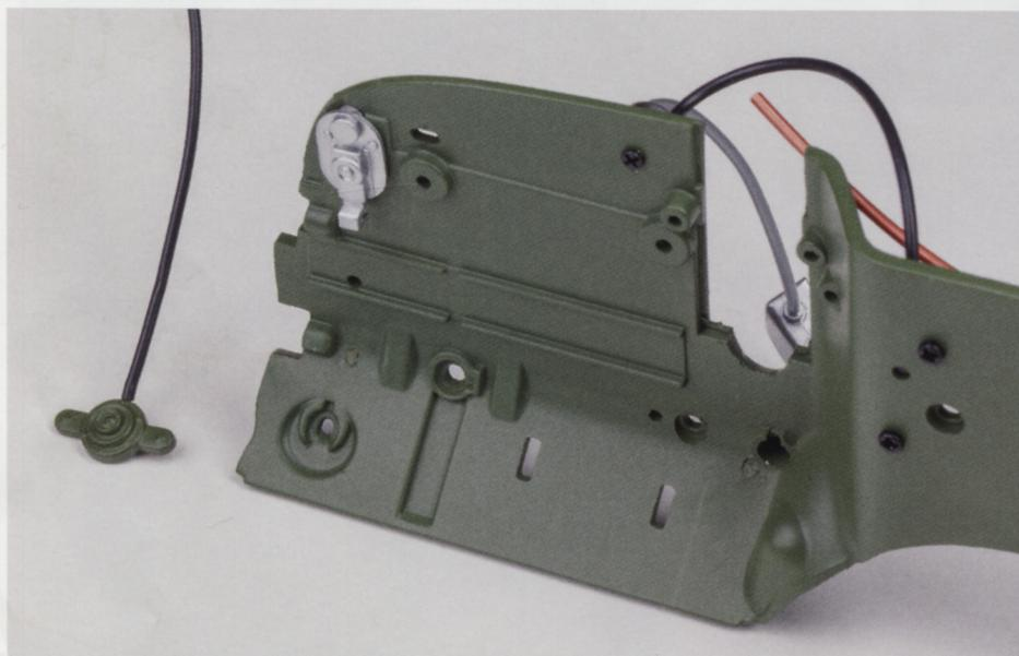
**Шаг 12.** Разместите корпус насоса ножного стеклоомывателя на поперегородке моторного отсека рядом с прорезями под педали тормоза и сцепления. Закрепите деталь при помощи винта 1,7×4 (AP).
