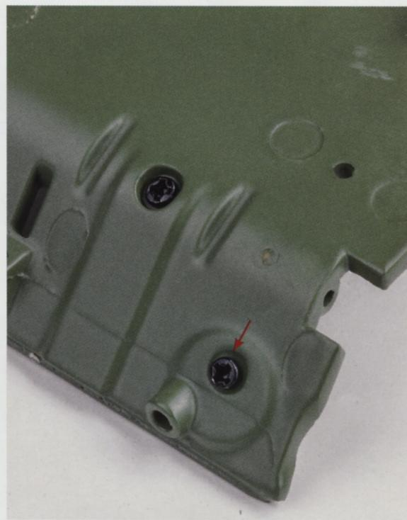
**Шаг 14.** В левом нижнем углу перегородки, со стороны салона, установите и закрепите винтом 1,7×4 (АР) ножной переключатель света.
