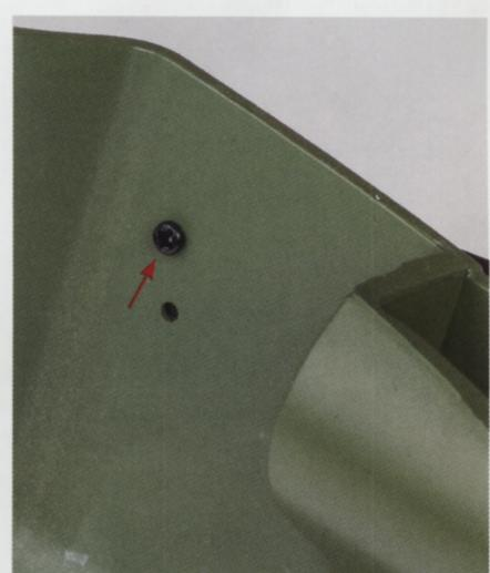
**Шаг 7.** На перегородку моторного отсека, рядом с установленным ранее кожухом вентилятора отопителя, поместите щиток управления предпускового подогревателя. Для фиксации детали используйте винт 1,7×4 (АР).
