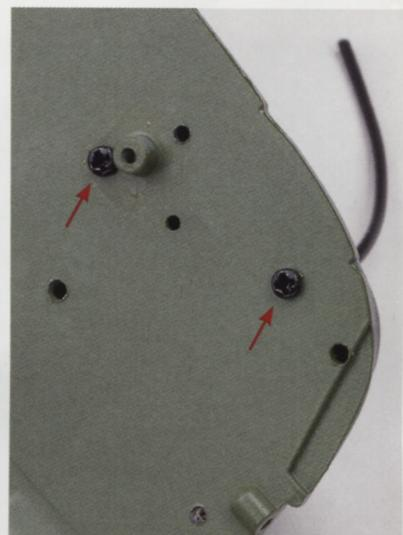
**Шаг 5.** Накройте установленный ранее шланг кожухом вентилятора отопителя. Совместите крепежные отверстия кожуха и перегородки и закрепите детали двумя винтами 1,7×4 (АР) с обратной стороны перегородки.
