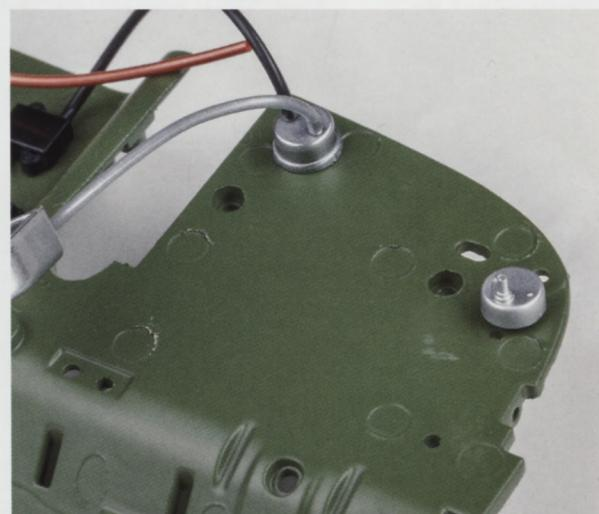
**Шаг 9.** В левой половине перегородки моторного отсека, со стороны двигателя, установите корпус выключателя массы. Плотно прижмите деталь к перегородке.
