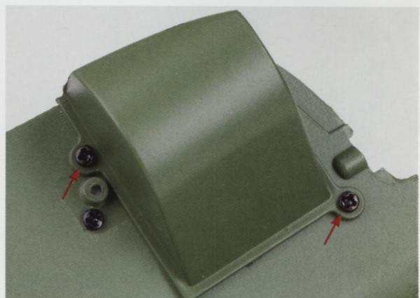
**Шаг 6.** На внутренней стороне перегородки моторного отсека, в ее правой половине, установите и закрепите двумя винтами 1,7×4 (СМ) приемный кожух.
