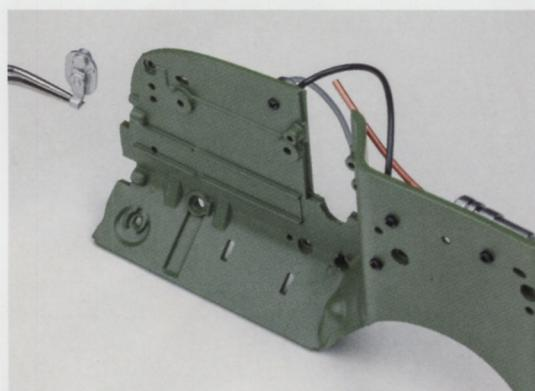
**Шаг 10.** С обратной стороны перегородки, со стороны салона, установите и закрепите винтом 1,7×3 (КР) крышку выключателя массы.
