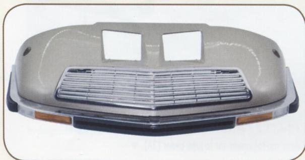
**3-10** PRÉSENTEZ LE PARE-CHOC AVANT (3C) sur l'ensemble de la jupe avant (3A) et de la grille frontale inférieure (3B). Fixez la partie centrale du pare-chocs avant (3C) avec une vis IM et les deux parties latérales avec deux vis KM. ▼
